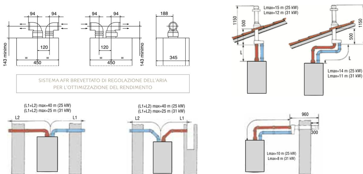
In caso di lunghezza del condotto di scarico superiore a 6 metri, è necessario installare il kit raccogli condensa.
